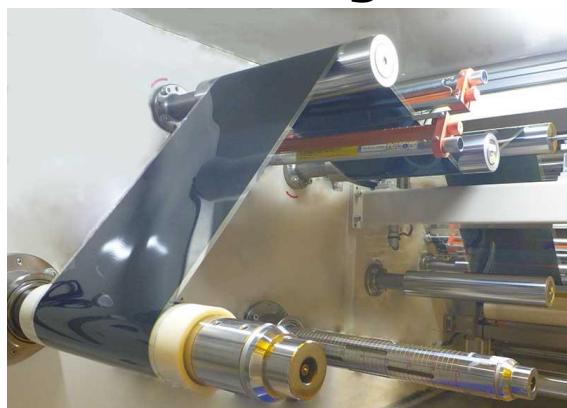
連続印刷の様子 出所：積水化学工業
